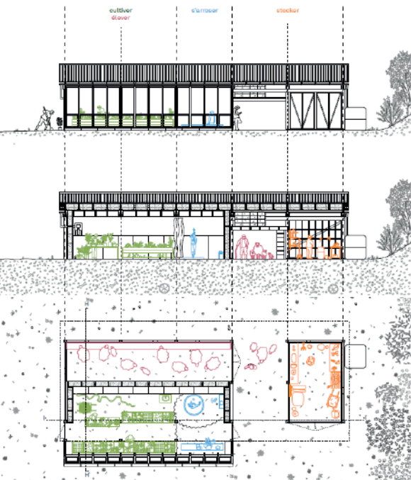
Projet « La recette locale » de Gauthier Gaillard, Nagy Makhoulf, Alice Ravelo de Tovar Serre bioclimatique : élévation, coupe longitudinale et plan - 1 : 150
