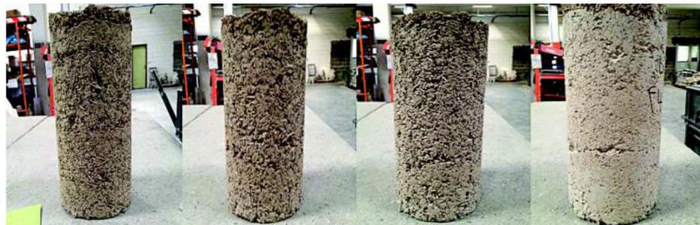
F 0 0 % granulats recyclés 100 % chènevotte F 20 20 % granulats recyclés 80 % chènevotte F 50 50 % granulats recyclés 50 % chènevotte F 100 100 % granulats recyclés 0 % chènevotte
