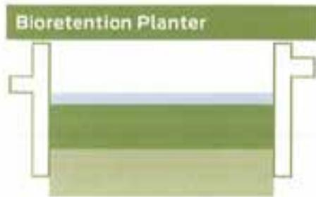
Installation de rétention d'eau avec des côtés verticaux murés, zone à fond plat et une grande capacité de surface pour capturer, traiter et gérer le ruissellement des eaux pluviales.
