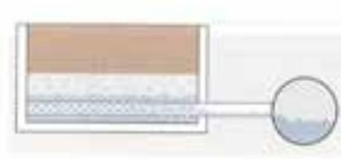
Retirer des particules et autres polluants en filtrant les eaux de ruissellement à travers des matériaux poreux tel que le sable, la terre ou d'autres filtres.
