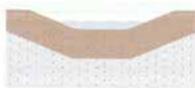
Capter et retenir l'eau sur site afin de réduire les eaux de ruissellement vers les égouts. L'eau ensuite s'évapore, transpire, ou s'infiltré à travers le sol.
