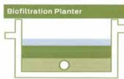
Capter et traiter le ruissellement des eaux pluviales. Eliminer les polluant en utilisant des matières végétales pour s'infiltrer et favoriser le règlement des particules.
