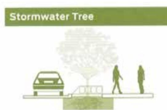
Arbre planté dans un puits fossé, pour maximiser la rétention des eaux pluviales, généralement situé proche de la gouttière de la rue permettant à l'arbre de gérer le ruissellement des eaux.
