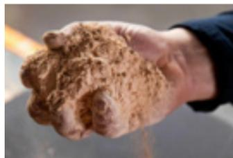
Breveté, il est composé de boues d'argile que l'on obtient après le lavage des carrières, de granules issus de la fonte d'acier et de gypse, roche que l'on retrouve notamment dans les déblais du Grand Paris. « Vous n'avez plus besoin d'aller chercher du calcaire dans des carrières ni de le cuire à 1 450 degrés pendant 18 heures en utilisant du charbon », illustre Julien Blanchard, le président de HGCT
