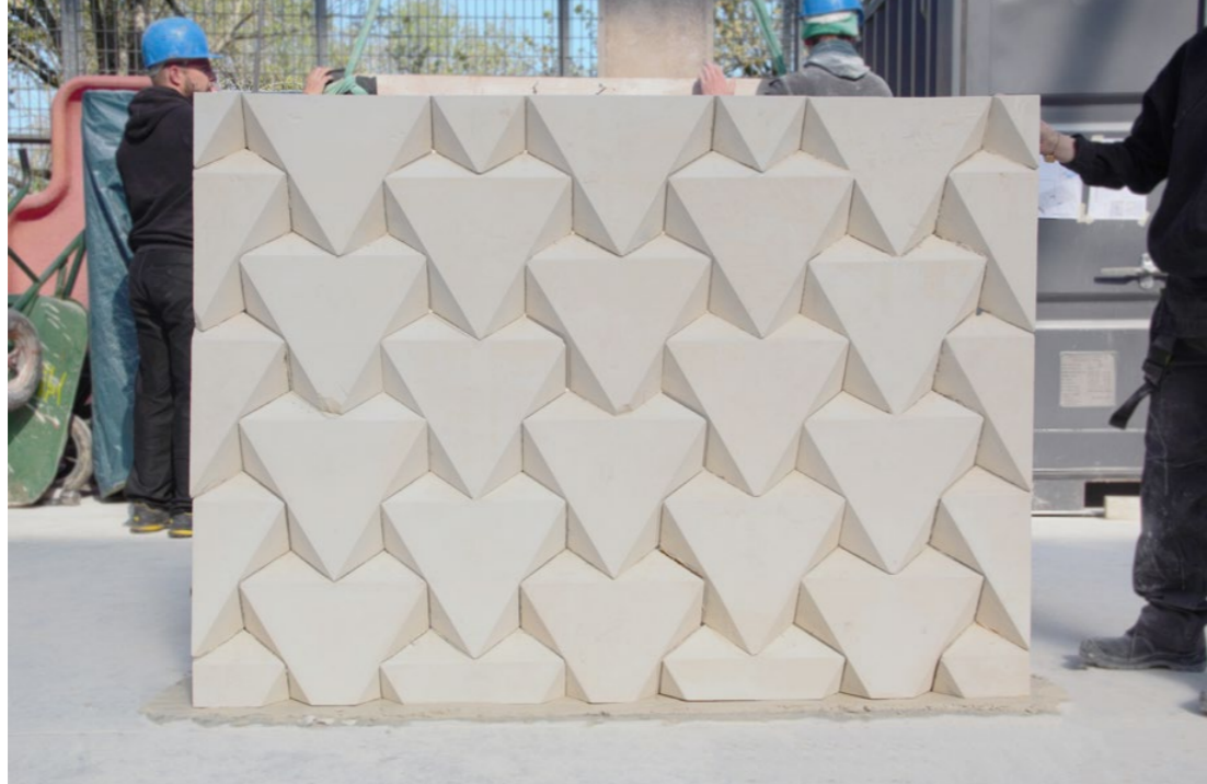
Prototype d'Octamur issu d'un processus informé de conception-fabrication d'enveloppe autobloquante en pierre © Anahita Mirani
