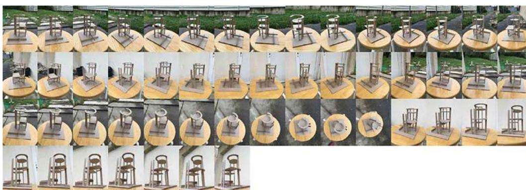
FIGURE 1.3 – Série de cinquante-deux prises de vue autour d’une maquette physique en vue de sa numérisation 3D par photogrammétrie
