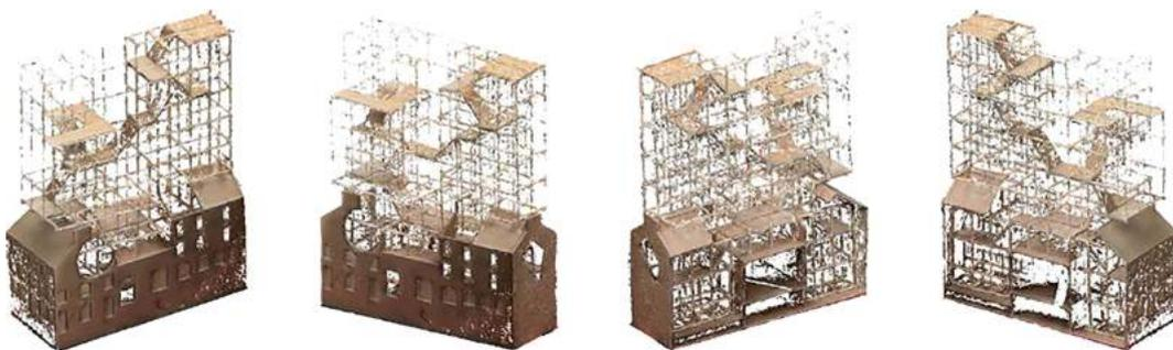
FIGURE 1.6 – Un résultat peu concluant de numérisation 3D d'une maquette physique sans doute dû à l'échelle des tourillons en balsa de 2 mm de diamètre
