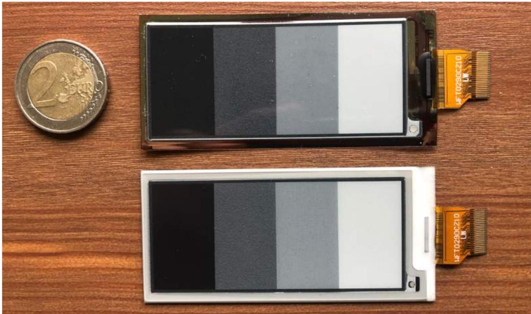
FIGURE 6.13 – Photographie des échantillons d'analyse affichant les 4 niveaux de gris.
