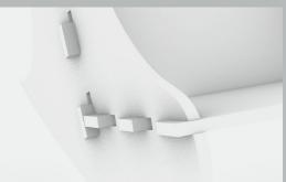
Nous avons donc sélectionné un assemblage à encoches avec clés :
